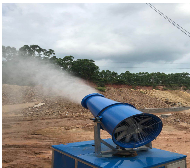
堆场喷雾装置
