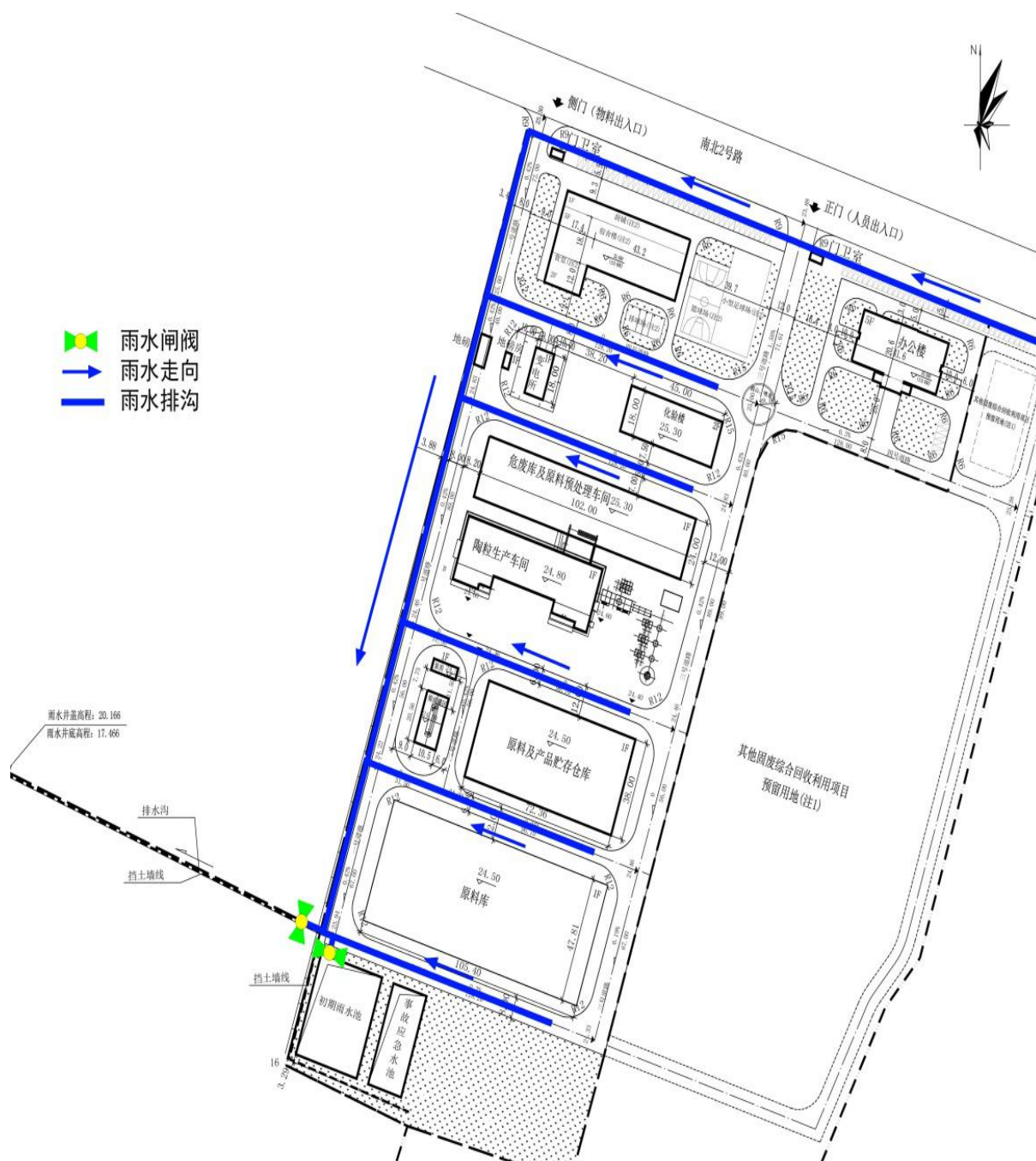
图 4-2 项目雨污水流向及封堵系统图
