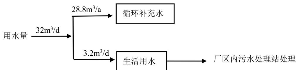
图 2.2-1 项目水平衡图
