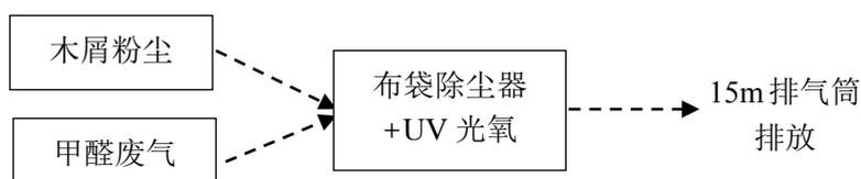
图 4-3 木屑粉尘、甲醛废气处理流程
