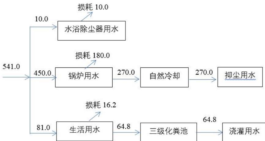
图 2-4 项目水平衡图 (m<sup>3</sup>/a)
