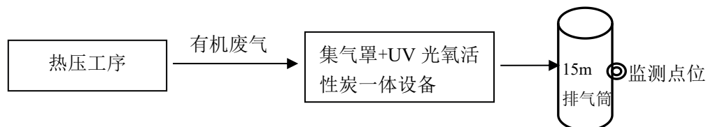
图 3-4 热压工序废气处理工艺流程
